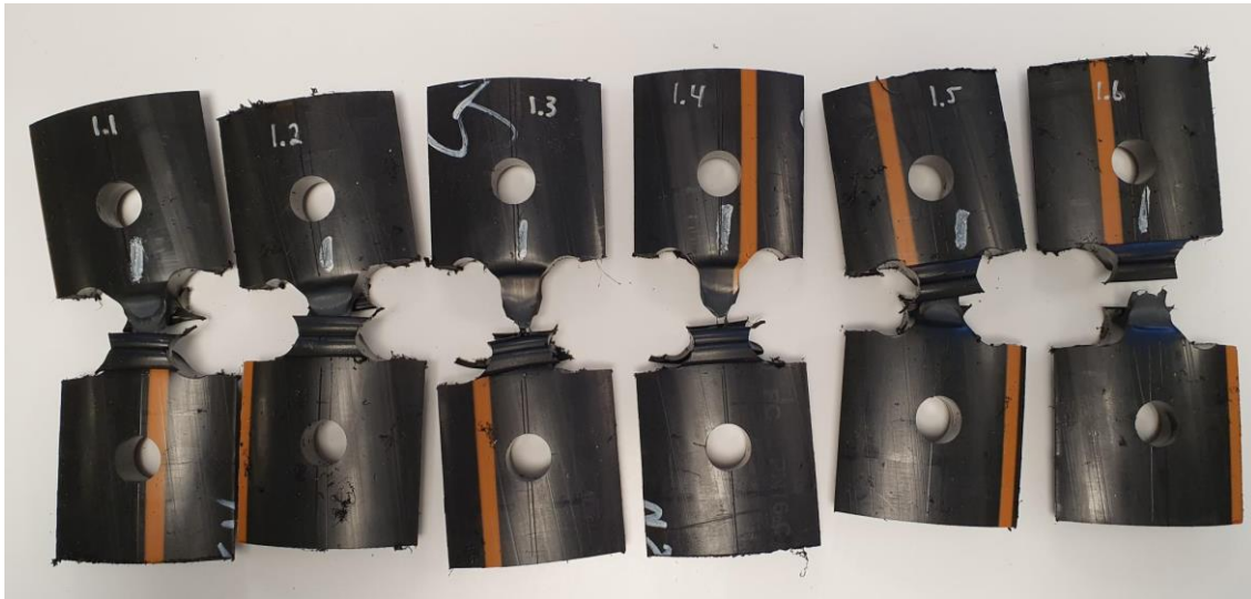
Figur 3: Speilsveis nr. 1 etter test
