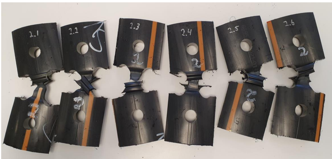
Figur 4: Speilsveis nr. 2 etter test
